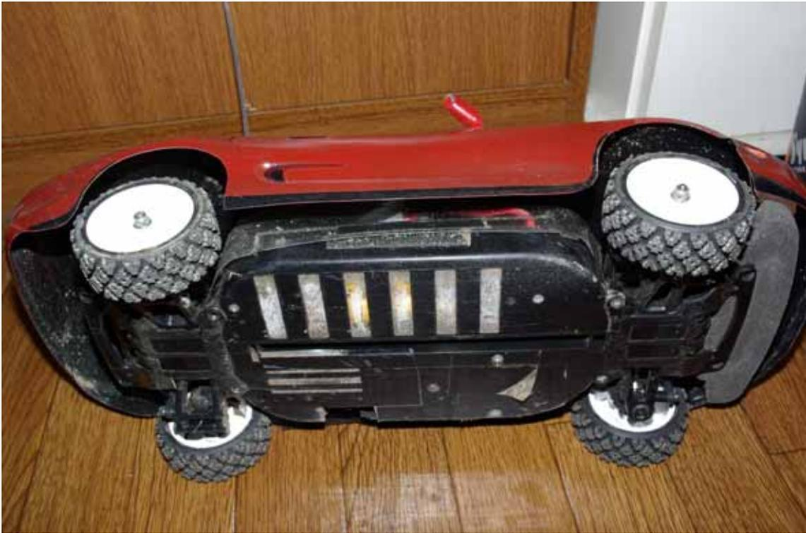
サスアーム下のアンダーカバーを加工しています（リバウンドと車高が稼げる）
