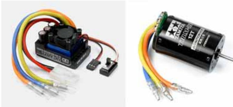
タミヤ・ブラシレスモーター01 12T と専用 ESC(スピードコントローラー)をセットしました。ブラシレスモーター01 は、23T ブラシモーターに相当。ESC01 は、5 種類のプリセットプロフィールに加え、10 段階のブレーキ出力、10 段階のニュートラルブレーキ出力などを個別に設定可能。温度、過電流、低電圧の 3 タイプの保護回路も搭載しました。電源はニカド、ニッケル水素をはじめリチウムイオンバッテリーにも対応します。
